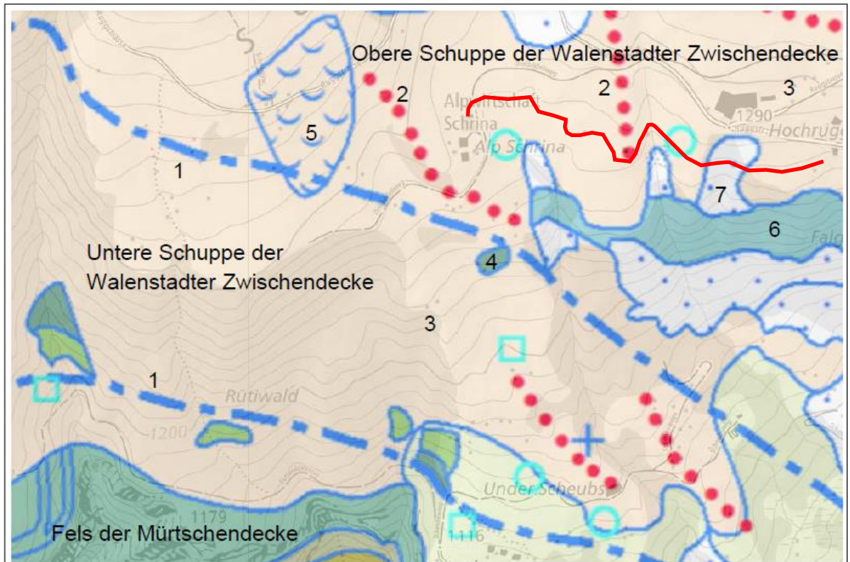
Fig. 1: Ausschnitt aus der geologischen Karte der Schweiz ( https://map.geo.admin.ch ); Legende: 1 = Grenze tektonische Überschiebung (Schuppengrenze), 2 = Moränenwall, 3 = Lockergestein aus Moränenschutt, 4 = Felsaufschluss Vitznaumergel, 5 = Vernässung, 6 = Quinten-Formation (Quintner Kalk), 7 = Hangschutt, Trockenschuttkegel — Projekt Kanalisation
